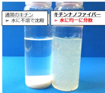
図 2. キチンとキチンナノファイバーの水分散性
